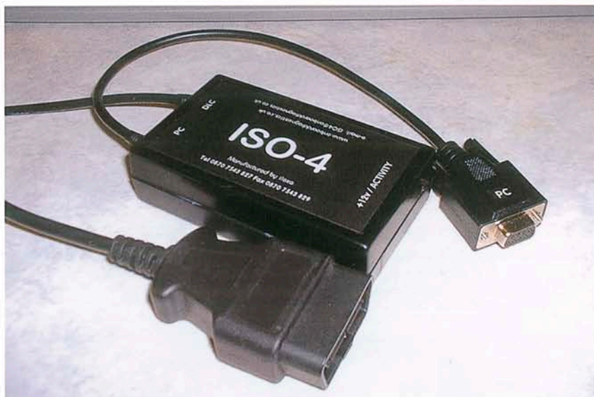
Figura 7. Versión de Elektor de un conversor OBD-2 a RS232. Este diseño utiliza un microcontrolador PIC.
